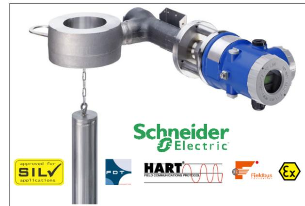
本液位计结合了 FOXBORO 丰富的经验, 采用了最先进的数字技术。该系列变送器所有传感器、放大器, 扭力传递组件、表壳组件、散热组件等表头关键部件均是 FOXBORO 公司提供的原装244LD产品, 整机出厂按原装标准执行。浮筒的浮力通过浮筒杆和扭矩管被传递到传感器的工作杆, 然后作用在传感器元件的自由端。4 个薄膜金属应变测量元件被喷溅到传感器元件上, 随拉或压力改变阻值。这 4 个薄膜金属应变测量元件连接成由放大器供电的惠斯通电桥, 和有效重量成正比的对角桥路电压被作为输入信号反馈到电子放大器。通过电子放大器该电压被转换为 4 ~ 20mA 二线制输出信号。
