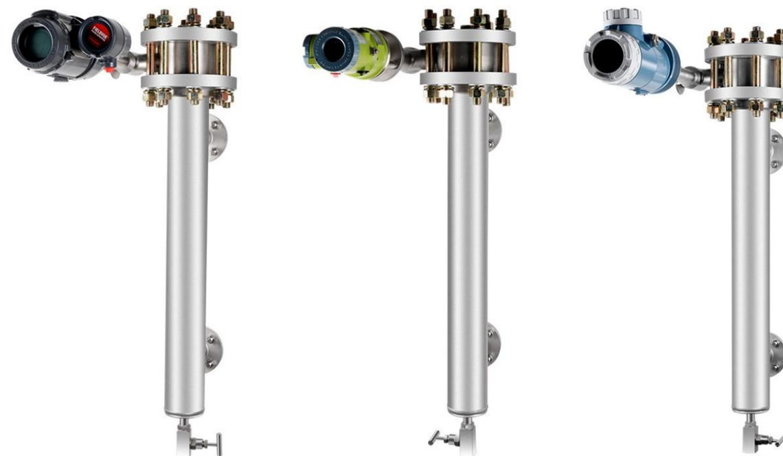
UTD 系列智能浮筒液（界）位变送器由智能液位控制器（表头）与测量室、测量机构、浮筒、扭力管组件等组成。被测介质液位的变化引起内浮筒所受力位置的变化，该变化被传递到扭力管组件上，使扭力管与芯轴同步转动。同时固定在扭力管芯轴上的磁钢组件发生旋转位移，改变了由霍尔效应传感器检测的磁场。该传感器将磁场信号转换为电信号。智能液位控制器采用控制器与相关的电子线路测量过程变量，提供电流输出，驱动液晶显示器（LCD）及提供 HART 通信能力。控制器接收经环境温度补偿与线性化的电信号，同时也可补偿由于过程温度变化而引起的液体密度的变化，输出并提供 4 ~ 20mA 电流输出信号。LCD 可显示模拟量输出、过程变量、过程温度（若安装了 RTD）扭力管旋转角度及变量的百分数范围等。
