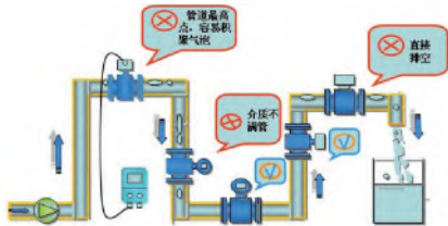
温馨提示：对于高处或位于井下等不利于观察操作的场所，使用分体型更方便观察和维护。
