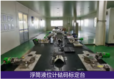
浮筒液位计砣码标定台
