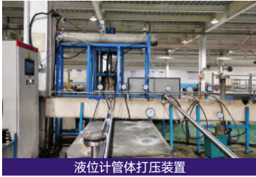
液位计管体打压装置
